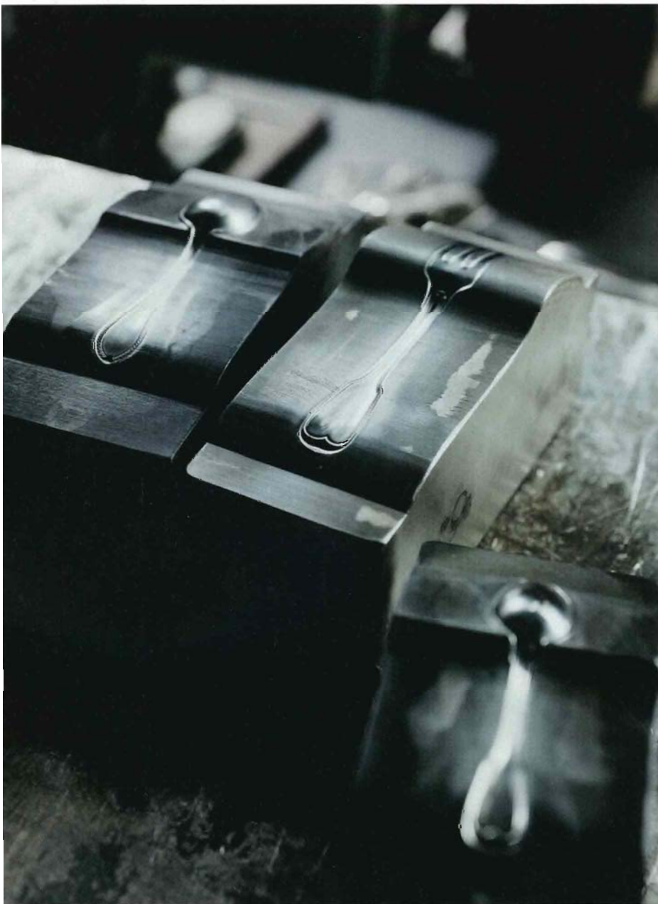
Die Formen zum Stanzen li., mit denen bei Robbe&Berking in Flensburg edles Silberbesteck gefertigt wird. Die Vorlagen für die verschiedenen Typen (g.o.) hängen in der Schleiferei. oben das Werkzeug, mit dem die Gravuren ausgeführt werden
